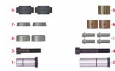
KISA PERNO : 30,90*77,5 , UZUN PERNO : 35*117 KALİPER PERNO BURÇ TAMİR TAKIMI KLP 2063
